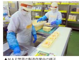
デリカサラダボーイ(株)宇多津工場では、2021年2月からMAP(ガス置換)商品の製造・販売を開始しました。MAPとは、Modified(置き換えられた)Atmosphere(空気/環境)Packaging(包装)の頭文字で、商品パッケージ内の空気を食品の保存に適したガスに置換して包装することです。
